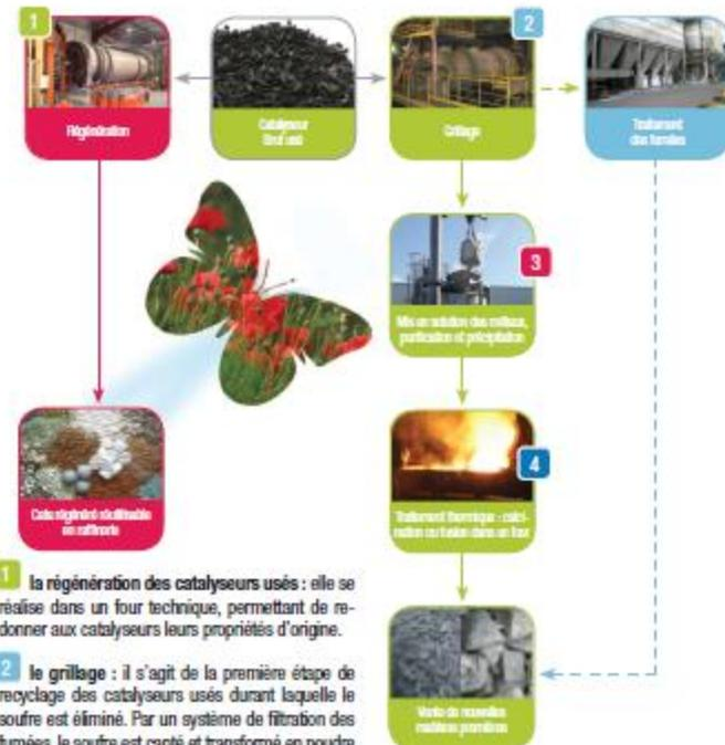
**1** la régénération des catalyseurs usés : elle se réalise dans un four technique, permettant de redonner aux catalyseurs leurs propriétés d'origine.
